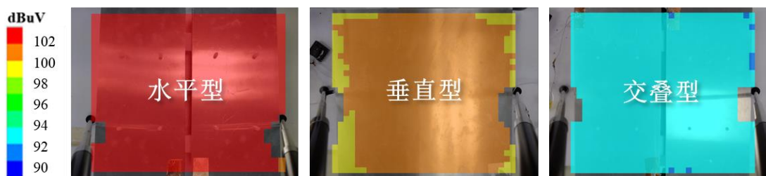
图 5.6 不同电容耦合器上实验平面处的场强分布
